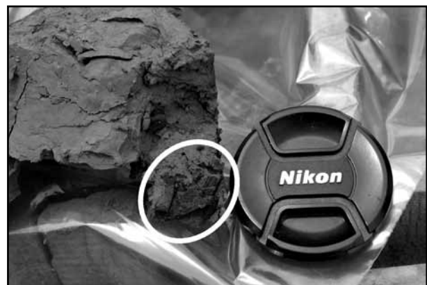
Obr. 3: Pohřbené fosilní dřevo na smykové ploše vzniklé sesuvným pohybem svahu, vrt Medláanky-1, hloubka 17,0 m.
